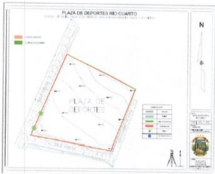
Levantamiento de detalles y curvas de nivel de la Plaza de Río Cuarto
