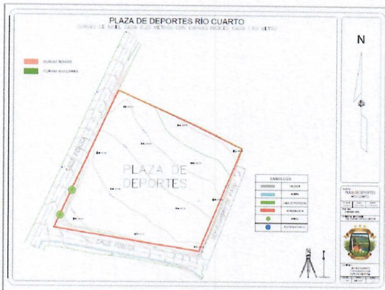
Levantamiento de detalles y curvas de nivel de la Plaza de Río Cuarto
